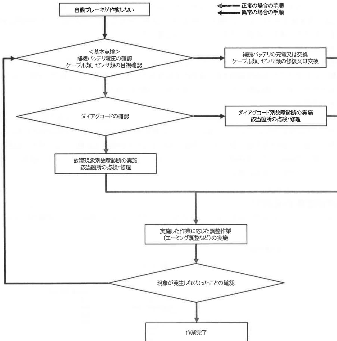
自動ブレーキには、複数のセンサー類を複合して制御を行っている場合もあり、原因と考えられるものが多岐にわたる。また、電子制御装置であるため、目視のみでは判断ができない場合がある。このため、不具合の原因として疑わしい箇所の絞り込みや、正常、異常の判断をするために以下の点検が重要になる。
